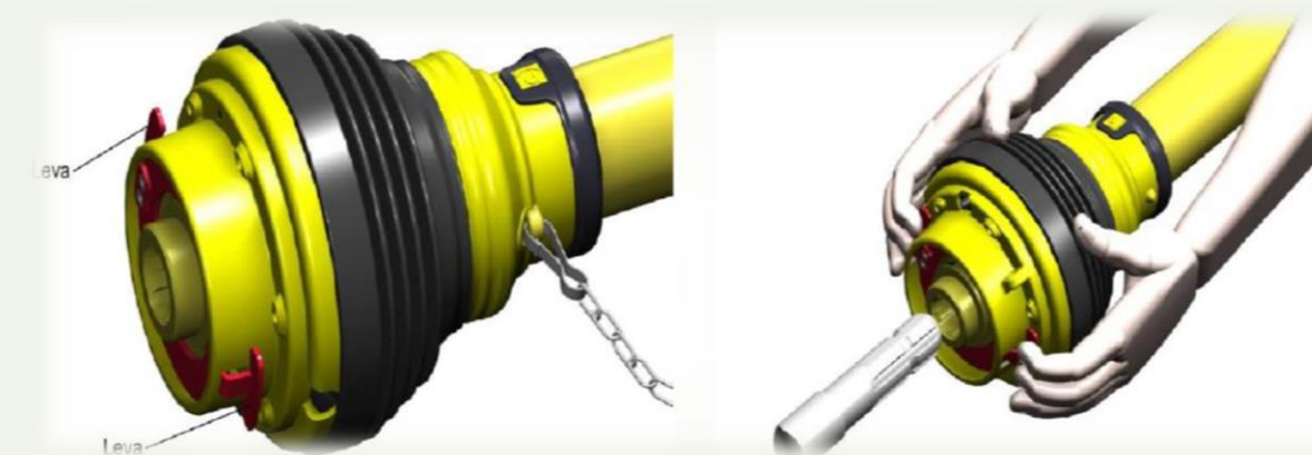
Abb. 5: Verbesserungsvorschlag zur Form der Verriegelung
