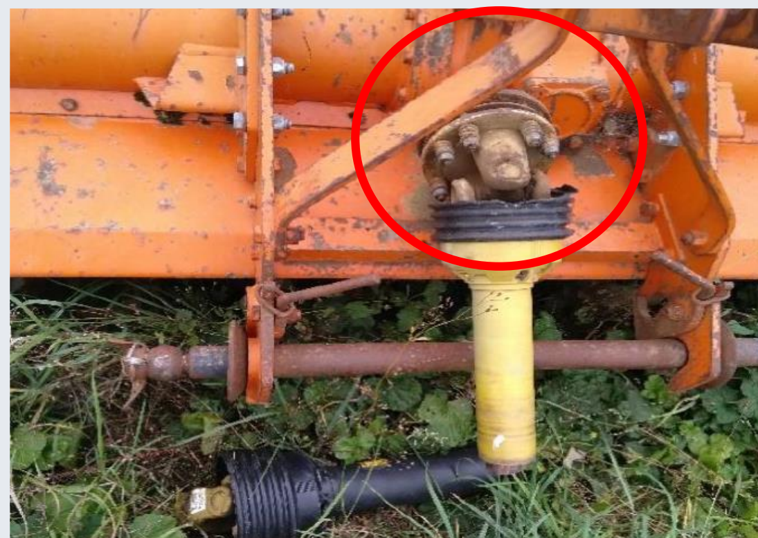
Abb. 1: Gelenkwelle mit mangelnder Instandhaltung
