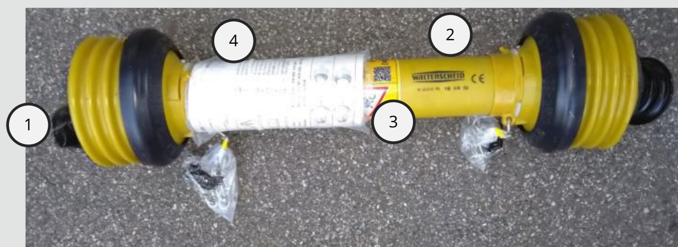
Abb. 2: Gelenkwelle mit Anforderungen an Schutzeinrichtung
