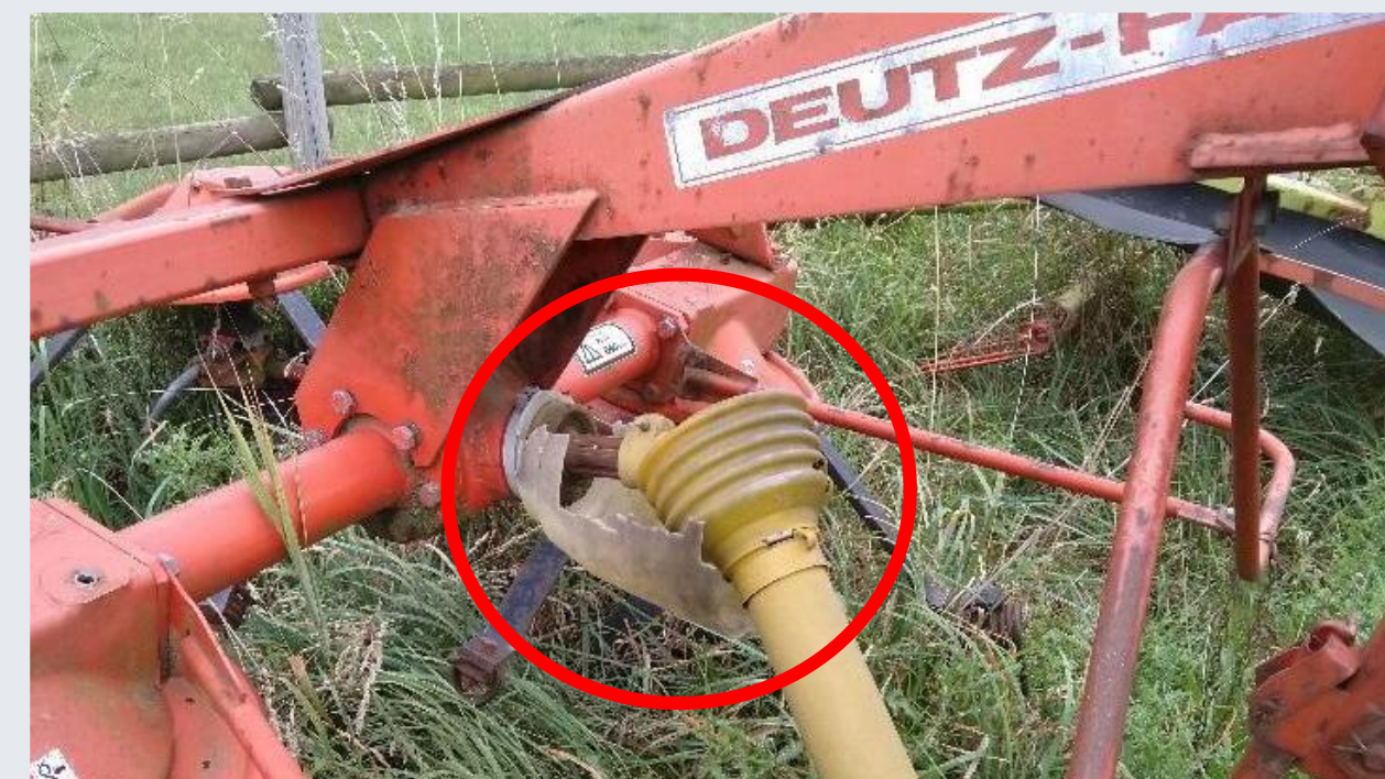
Abb. 3: Defekte Schutzeinrichtung aufgrund falscher Lagerung
